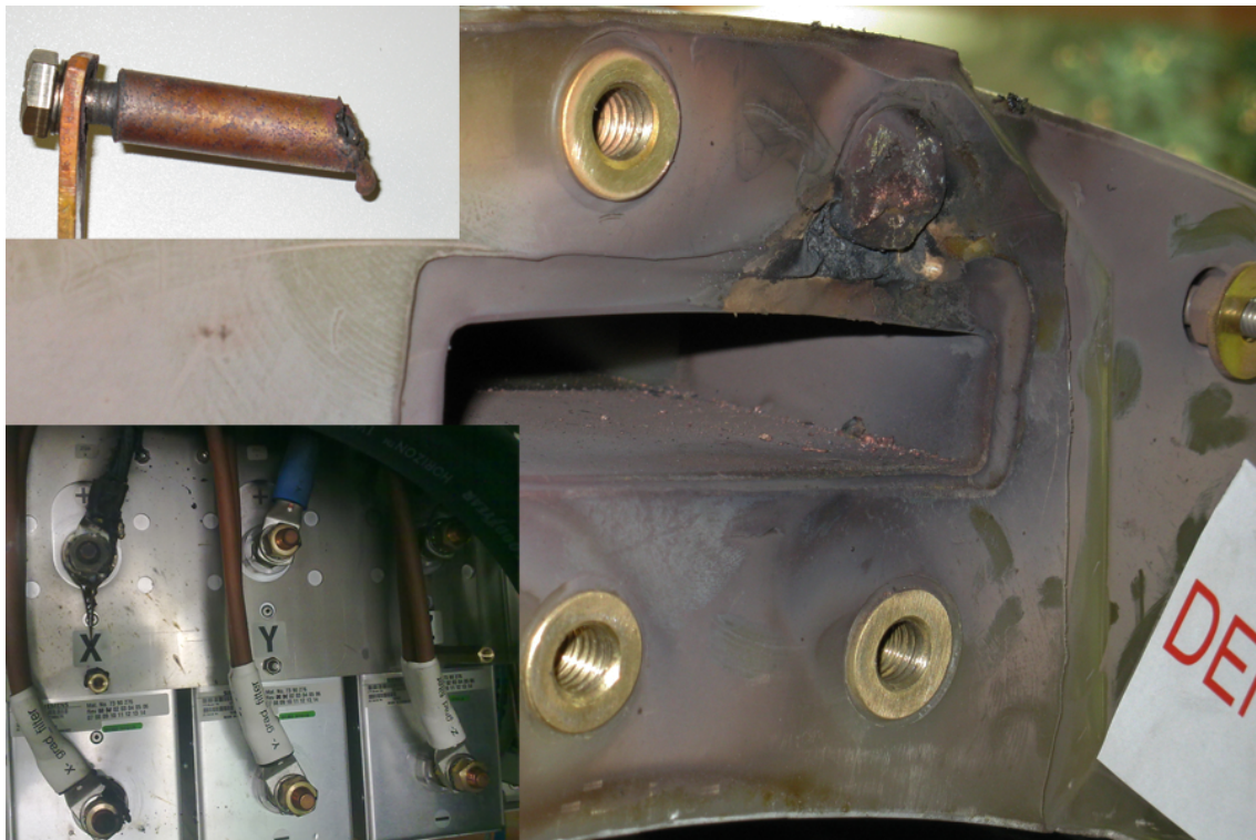
Abbildung 17: Unter dem EPI Read-out geschmolzene x-Gradienten. Die Phase wird zum Erhalt der Bildsymmetrie i.d.R. in der y-Achse kodiert, da in ihrer Richtung geometrische Verzerrungen in den EPIs entstehen, die mit dem Echo Spacing (ESP) steigen.
